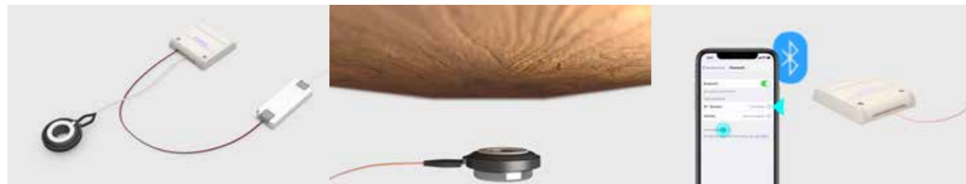
1 Collegamento speaker - amplificatore e amplificatore - alimentatore 12V - 20W
