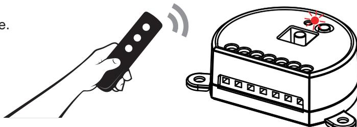
**AZIONE:** Invio di un comando con il trasmettitore    **LED:** Lampeggia 3 volte
